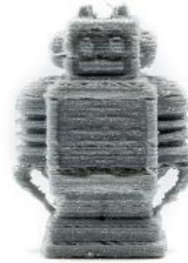
Ultimaker ロボットは押し出し不足の兆候を示しています
